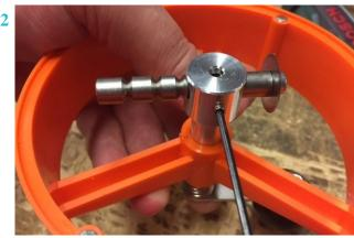
2. Utilice la llave Allen para aflojar el pequeño tornillo en el lado del brazo de corte. El brazo de la cortadora debe moverse ahora de lado a lado.
