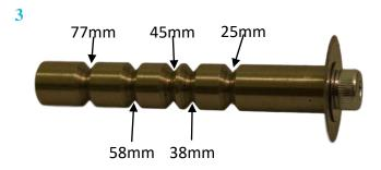
3. Mire a través del pequeño orificio en la parte inferior del brazo de corte para seleccionar la cresta correcta. Cada cresta cortará un tamaño de círculo diferente, como se muestra en la imagen.
